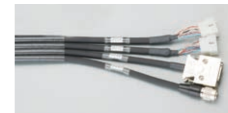
ハイフロンSD熱融着型フラット2重シースケーブル ハイフロンSD/20276及び2586シリーズにポリウレタンシースを押し出し熱融着により平型ケーブルに。
